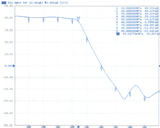
Рис.5. АЧХ для AVDN-L2(2) I-ch (dem3)
